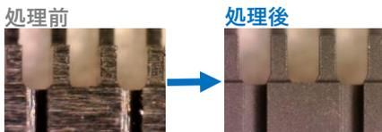
HPM31切削目金型磨き／バリ除去／ピン幅約170μm／処理時間約1分
