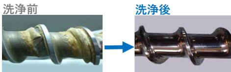
スクリーφ60mm／L=1500mm／付着樹脂：PEEK／洗浄時間：20分
