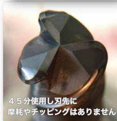
φ12 ラジウスエンドミルの 加工後の形状
