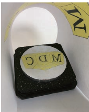
磨きレス微細模様および鏡面切削加工 (被削材：アルミ)
